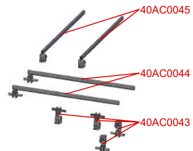
Support de coffrage carton entre 2 TOURS ECHELLES 40AC0042
